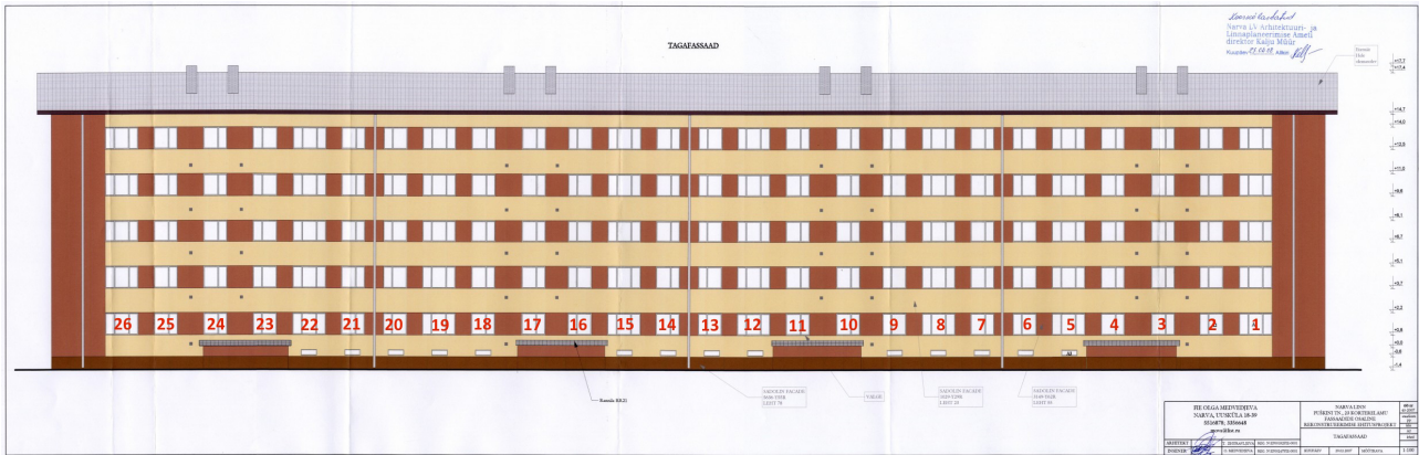
Joonis 3. Puškini 23 hoone analüüsitud 1. korruse aknad (hoovipoolne fassaad)
